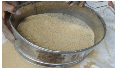
Gambar: 4.2 Penyaringan pasir silika
