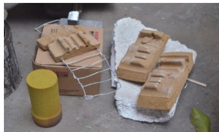
Gambar: 4.8 Bagian-bagian pola
