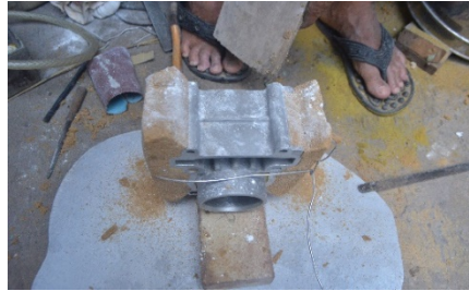
Gambar: 4.6 Pembuatan pola
