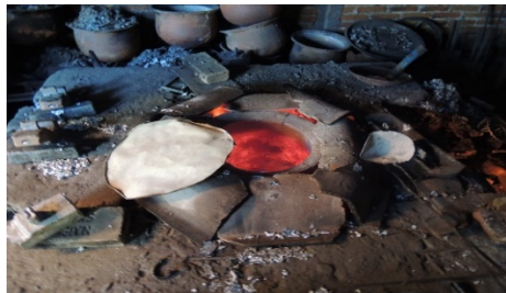
Gambar: 4.12 Proses peleburan
