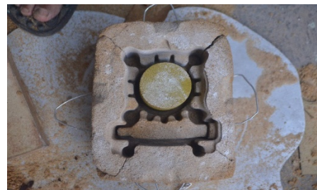
Gambar: 4.9 Pola yang sudah dirakit
