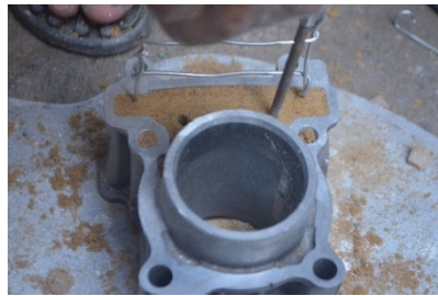
Gambar: 4.7 Pemberian gas CO 2 pada pasir silika
