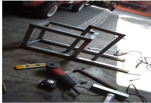
Gambar 4.5 proses pengamplasan sisa pengelasan menggunakan amplas grindra.
