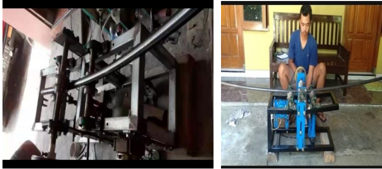
Gambar 4.10 dongkrak perlahan proses pengerolan.
