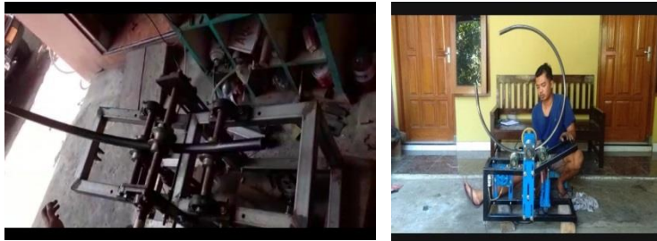
Gambar 4.15 pastikan seluruh pipa terkena pengerollan.
