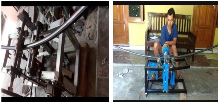
Gambar 4.11 melakukan pengerollan dengan maju dan mundur.
