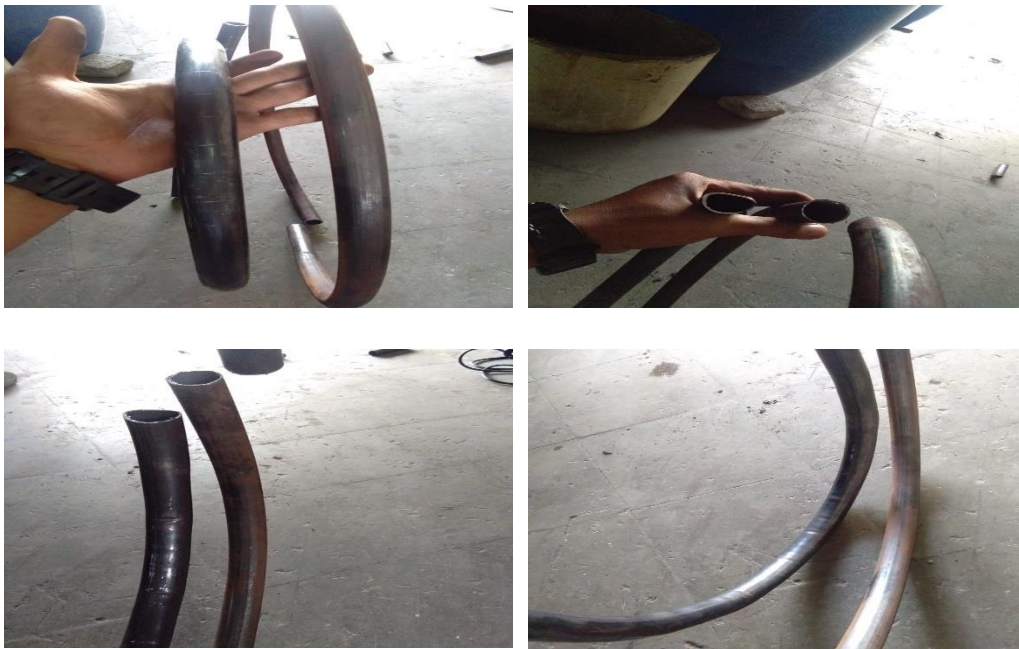
Gambar 4.21 perbandingan hasil proses pengerollan manual dan pengerollan semi otomatis.
