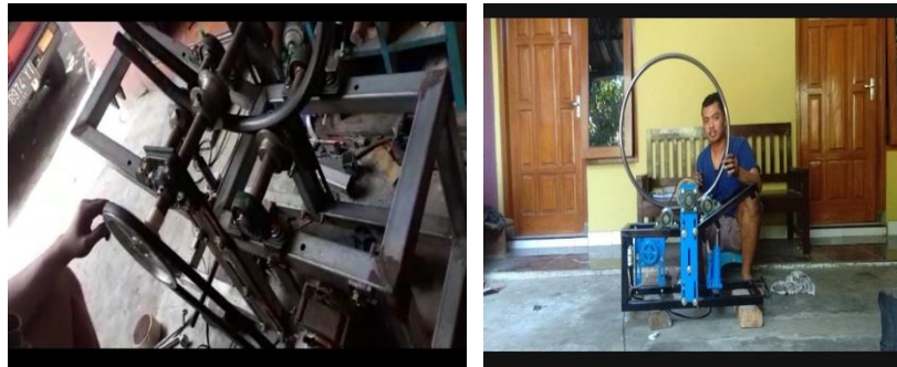
Gambar 4.18 proses pengerollan sudah selesai.
