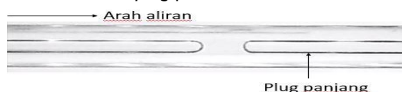
Gambar 5. Pola aliran plug pada J_G = 0,207 m/s, J_L = 0,0232 m/s
