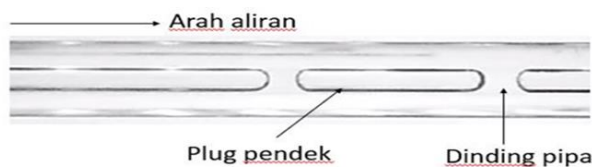
Gambar 3. Pola aliran plug pada J_G = 0,207 m/s, J_L = 0,091 m/s
