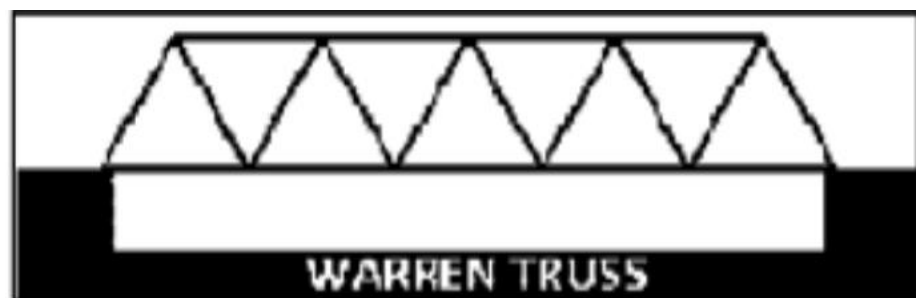
Gambar 2.7. Jembatan rangka tipe warren (Satyarno, 2003)
