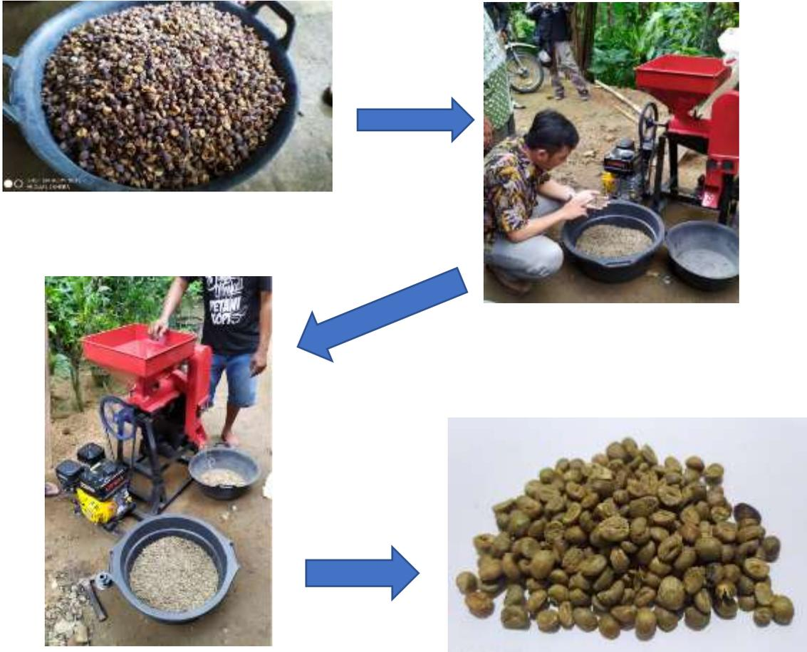
Gambar 5. Proses pengupasan kulit ari biji kopi kering.
