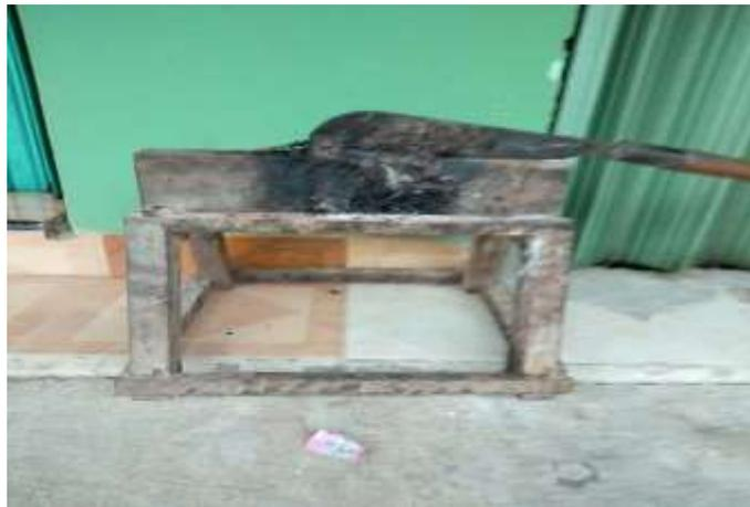
Gambar 1. "Kecip" Alat pengupas biji mete secara manual
