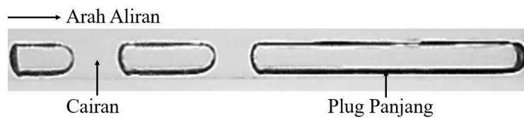
Gambar 2. Pola aliran plug pada J_G = 0,025 m/s, J_L = 0,539 m/s
