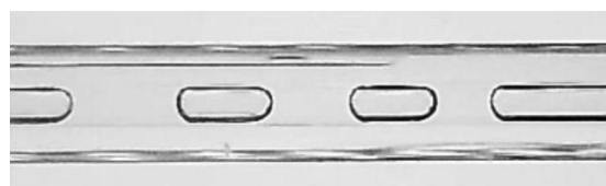
Gambar 16. Fraksi hampa pola aliran plug pada J_G = 0,116 m/s, J_L = 0,149 m/s
