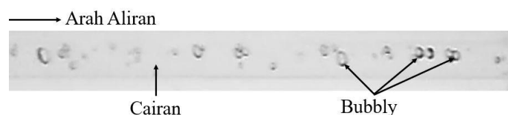
Gambar 5. Pola aliran bubbly pada J_G = 0,423 m/s, J_L = 0,879 m/s
