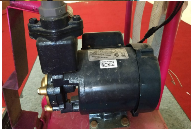
Gambar 3.4. Pompa air SHIMIZU 128 BIT
