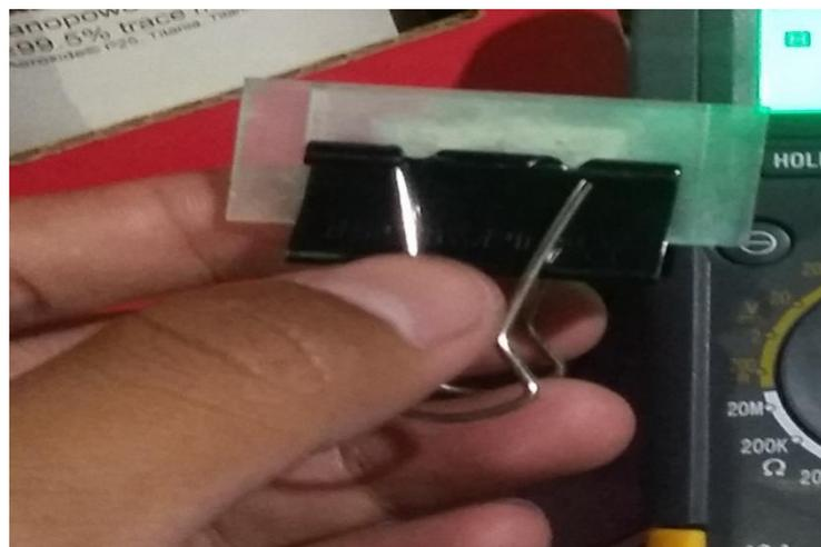
Gambar 4.2. Pengukuran Kaca Konduktif yang Sudah di Spray
