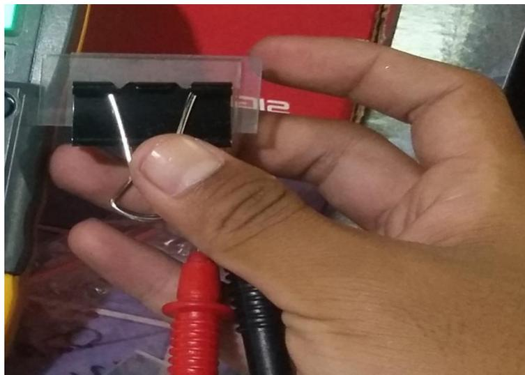
Gambar 4.1. Pengukuran Kaca Konduktif yang Belum di Spray
