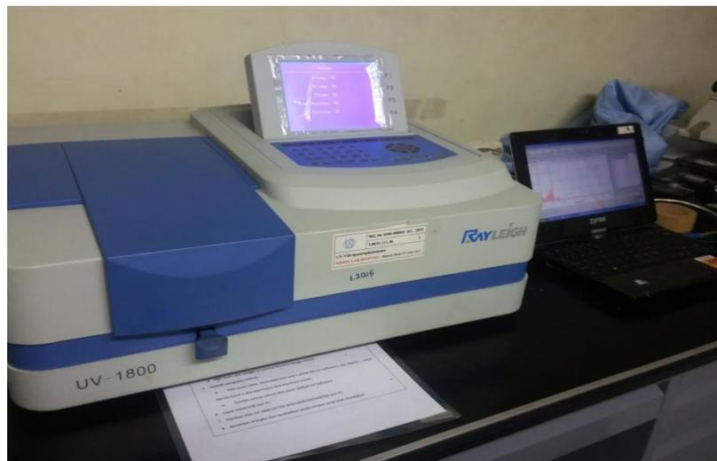
**Gambar 3.5.** Alat Spektrofotometer UV-VIS
