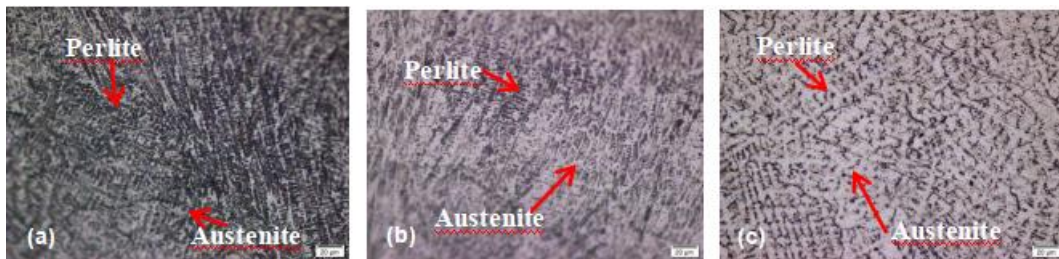
Gambar 3.6 Struktur mikro perbesaran 500x pada daerah weld metal dengan variasi tegangan listrik (a) 1,6 Volt, (b) 1,79 Volt, (c) 2,02 Volt.
