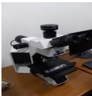
Gambar 3.3. Alat Uji Struktur Mikro mikroskop optik usb tipe Olympus U-MSSP4.
