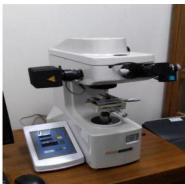
Gambar 3.4 Alat uji kekerasan *vickers*
