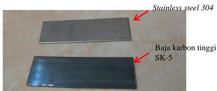
Gambar 3.5 Material plat logam untuk pengujian
