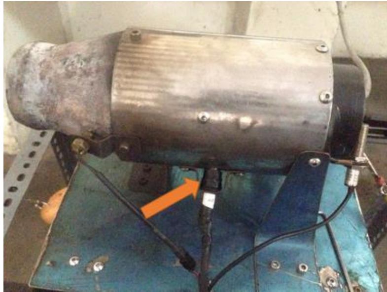
Gambar 4.30 Posisi busi pada engine
