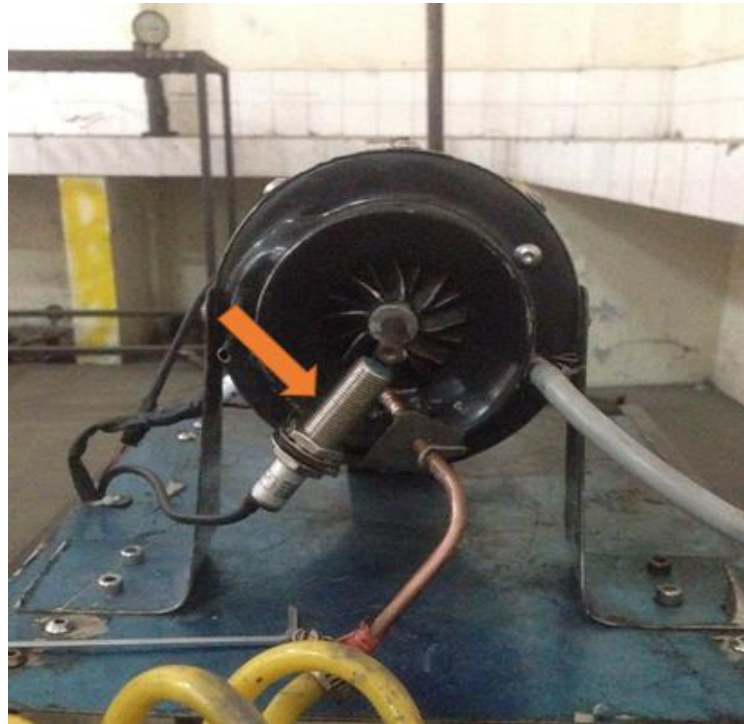
Gambar 4.29 Posisi sensor RPM
