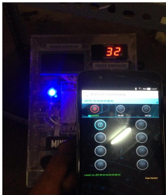
Gambar 4.34 Menjalankan sistem dengan control android
