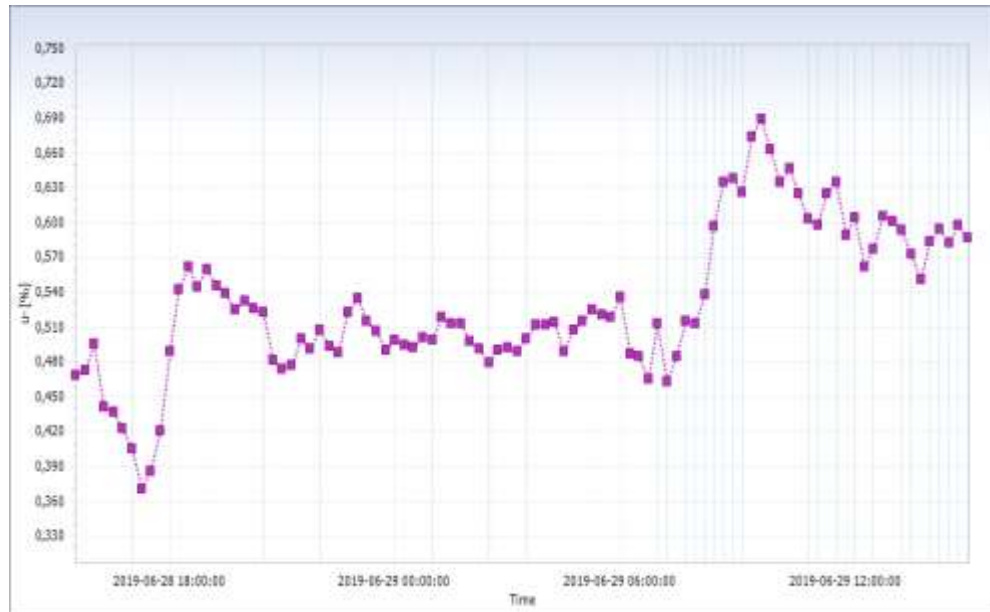
Gambar 4.23 Hasil Pengukuran Ketidakseimbangan Tegangan
