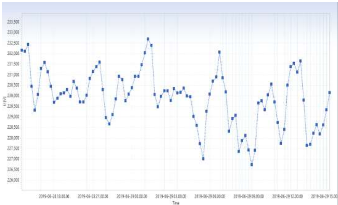
Gambar 4.2 Grafik hasil pengukuran tegangan fasa R
