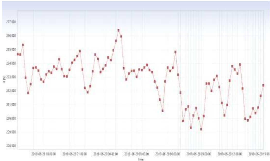
Gambar 4.3 Grafik hasil pengukuran tegangan fasa S
