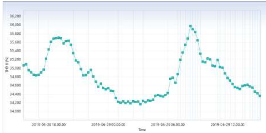
Gambar 4.17 Hasil Pengukuran Harmonisa Tegangan Fasa Netral
