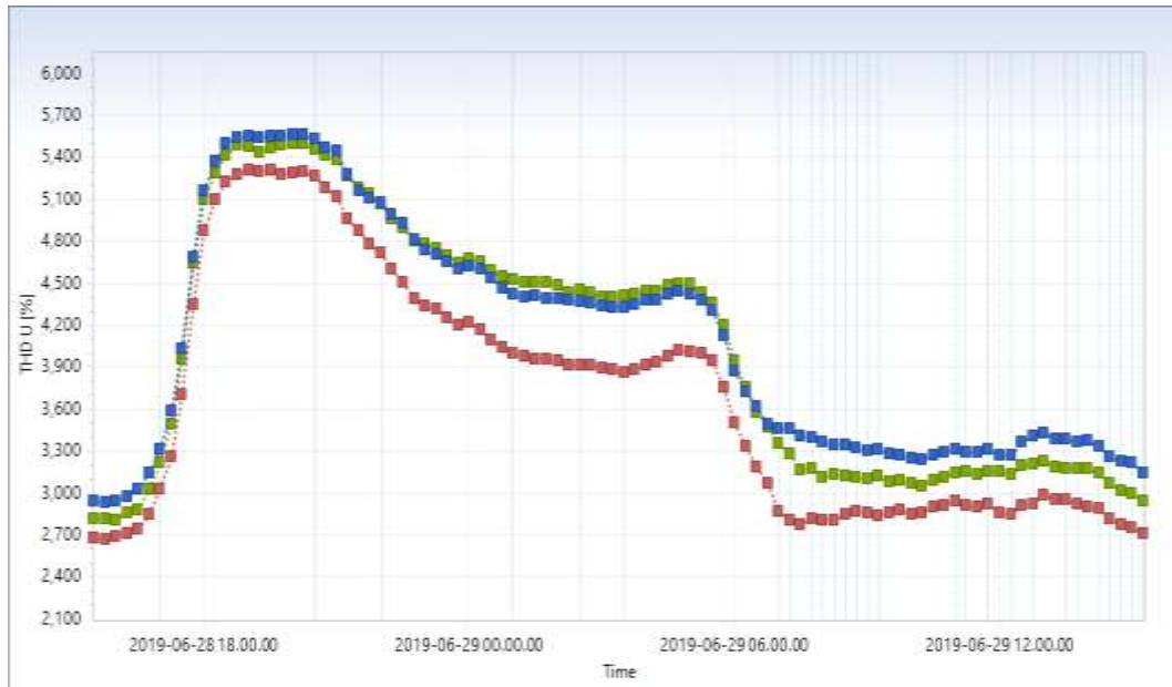
Gambar 4.13 Hasil Pengukuran Harmonisa Tegangan R,S,T
