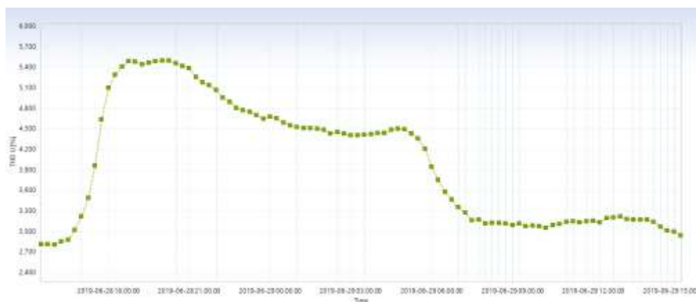
Gambar 4.6 Grafik hasil pengukuran Harmonik Tegangan fasa T
