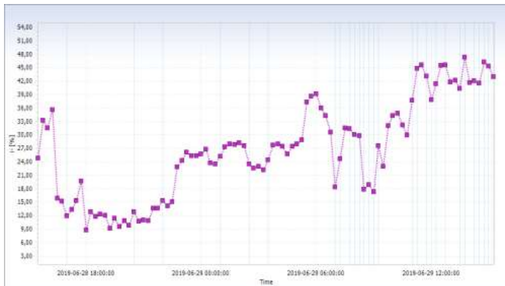
Gambar 4.24 Hasil Pengukuran Ketidakseimbangan Arus
