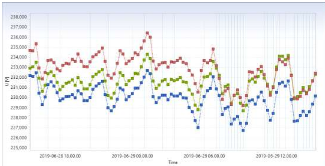
Gambar 4.1 Hasil Pengukuran Tegangan Fasa RST
