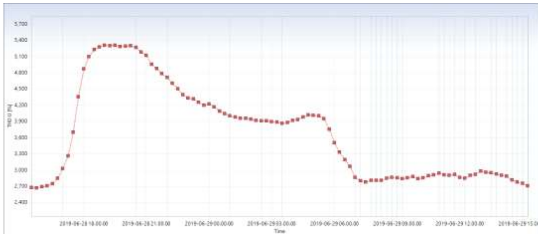
Gambar 4.15 Grafik hasil pengukuran Harmonik Tegangan fasa S
