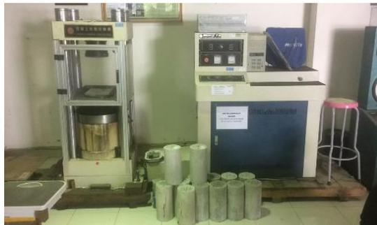
Gambar 3.19. Alat uji tekan statis beton
