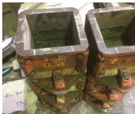
Gambar 3.15. Cetakan kubus beton
