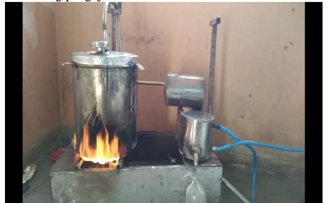
Gambar 3.4 Proses Pirolisis Pengambilan Minyak
