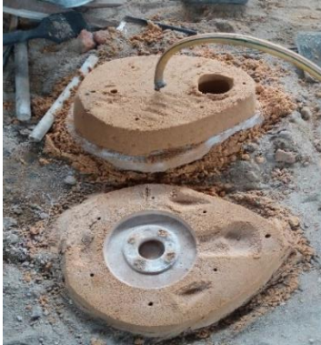
Gambar 3 Proses pengerasan cetakan pasir kering dengan gas \text{CO}_2 .
