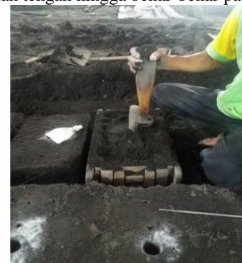
Gambar 2 Pemadatan cetakan pasir basah dengan penumbuk.
