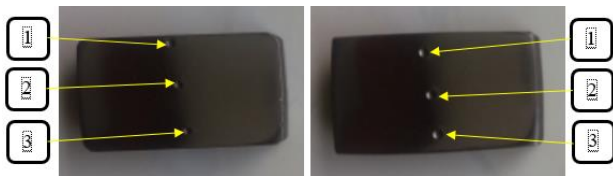
Gambar 14 Letak titik uji kekerasan.
