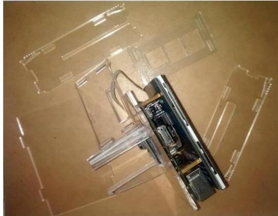
**Gambar 3.5** Pembuatan casing modul.
