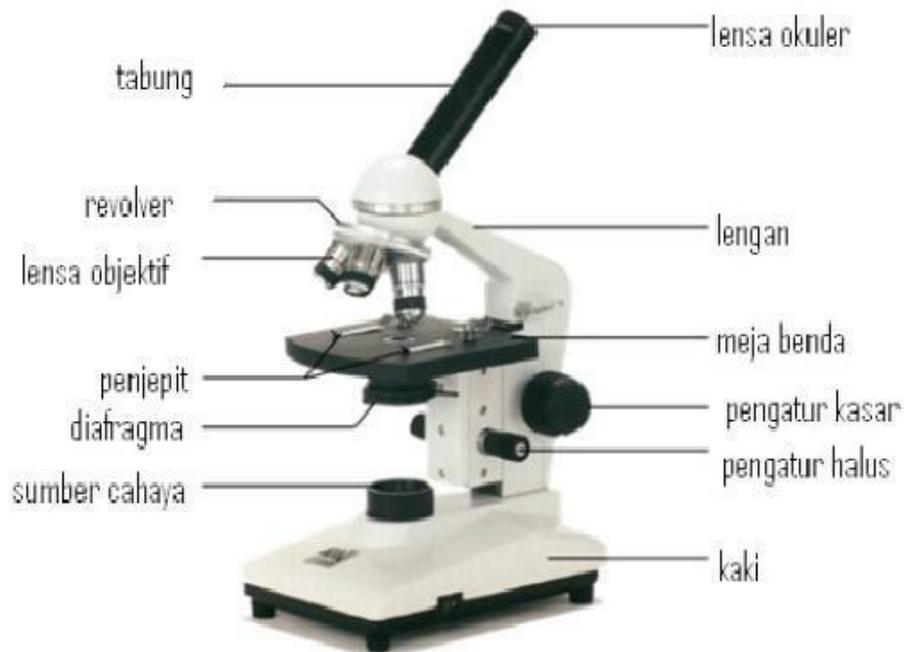
**Gambar 2.1** Bagian – bagian mikroskop[11]
