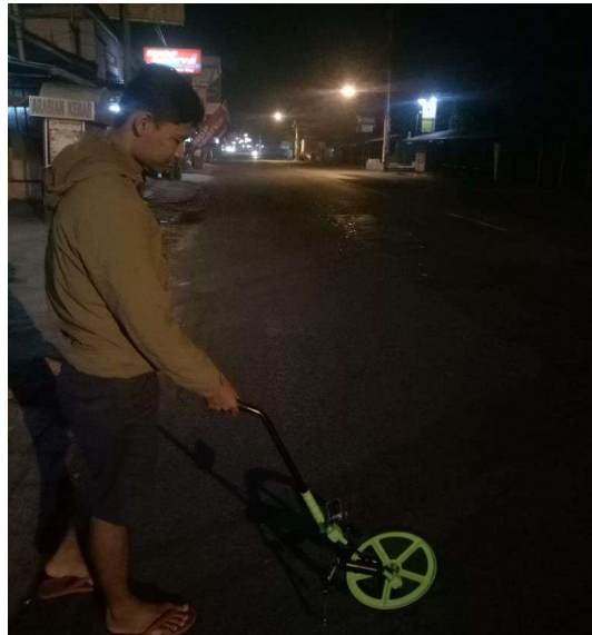
Gambar 3.5 Pengukuran Geometrik Jalan.
