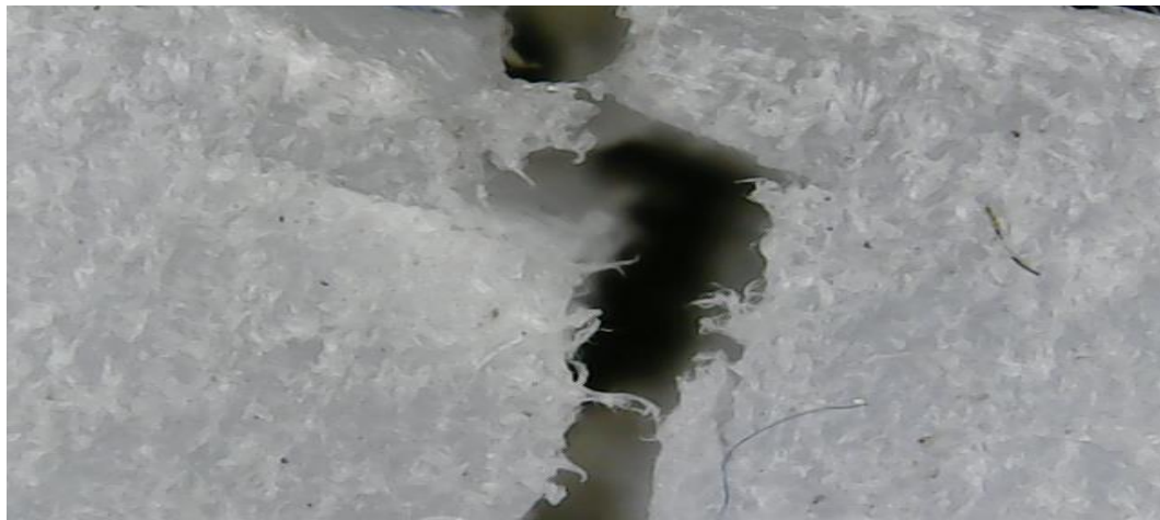
b. Patahan spesimen setelah diuji tarik
