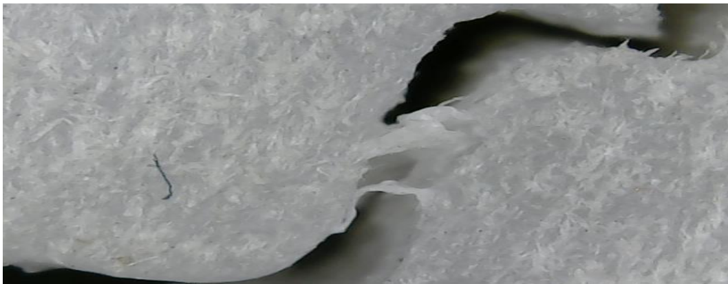
b. Patahan spesimen setelah diuji tarik
