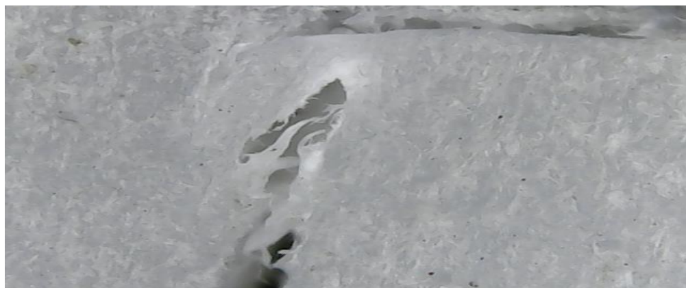
b. Patahan spesimen setelah diuji tarik
