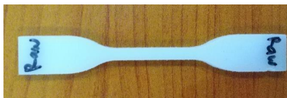
Gambar 3.16 Spesimen Uji Tarik ASTM D638 Type IV
