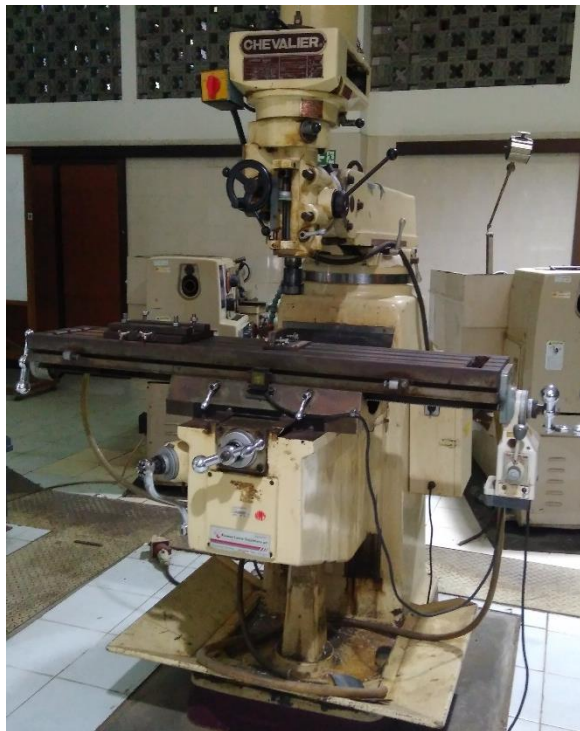
Gambar 3.2 Mesin Milling Vertikal
