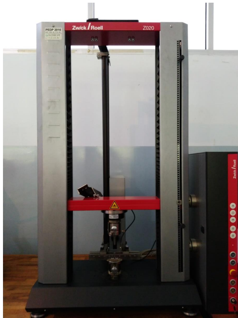
Gambar 3.4 Alat Uji Tarik dan Uji Bending
