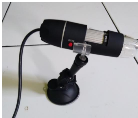
Gambar 3.3 Alat Uji Struktur Makro
