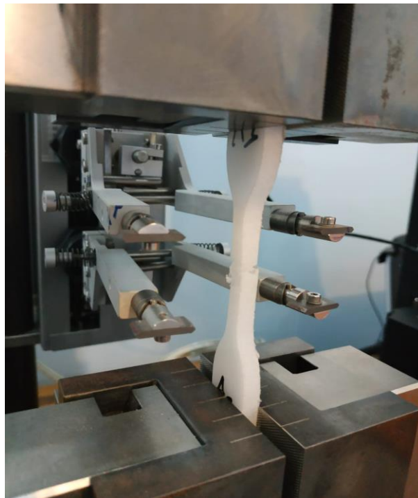
Gambar 3.20 Proses Pengujian Tarik
