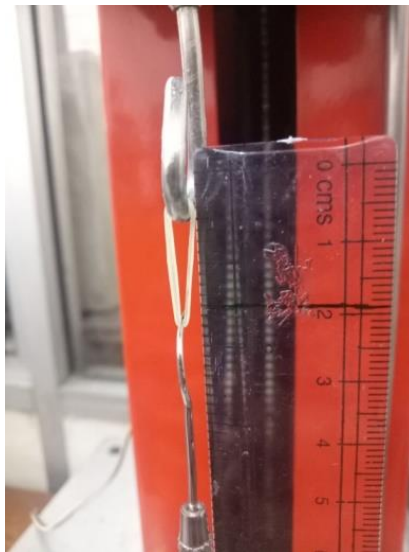
Gambar 7. Daya tarik menggunakan penggaris untuk memastikan tarikan tidak berlebih
