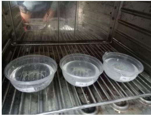
Gambar 10. Jig Bord dimasukkan ke wadah yang telah direndam 3 macam pH saliva
