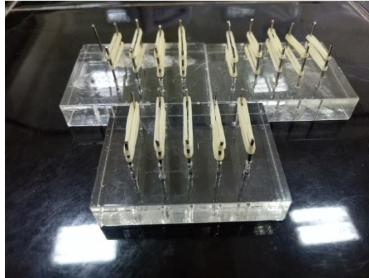
Gambar 8. Jig board yang telah dibentangkan elastik latek ortodonti untuk dilakukan perendaman
