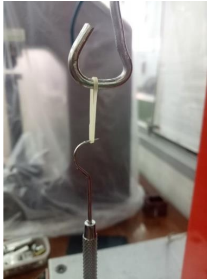
Gambar 6. Daya tarik menggunakan sonde dengan ditarik 3 kali diameter awal
