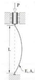
Gambar 2.48 Model kolom ideal dari Euler (Dewobroto, Struktur Baja Edisi ke-2, 2016).
