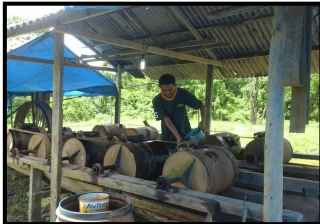
Gambar 2 : Penulis melakukan kegiatan penambangan pada saat pengelolaan dengan menggunakan tromol untuk pemisahan emas dengan material tanah dan bantu bercampuran butiran emas.
