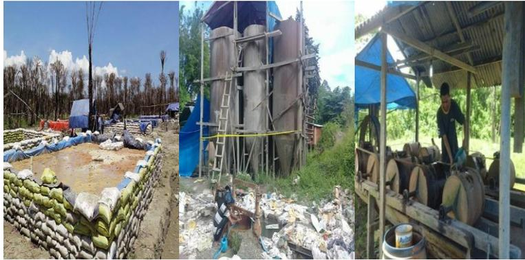
Gambar 1.1<sup>21</sup> : Pengelolaan emas yang dilakukan oleh masyarakat dengan cara Perendaman, Tong dan Mesin Tromol.
