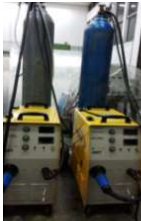
Gambar 3.4. Mesin Las Seri Tenjima MIG-200S
