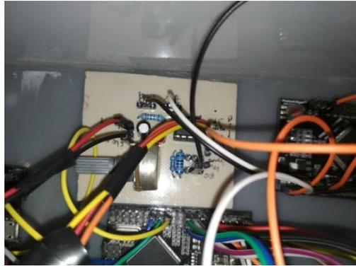
**Gambar 3.10** Rangkaian Sensor DS18B20
