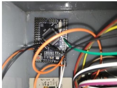
**Gambar 3.6** Rangkaian Arduino Mega 2560
