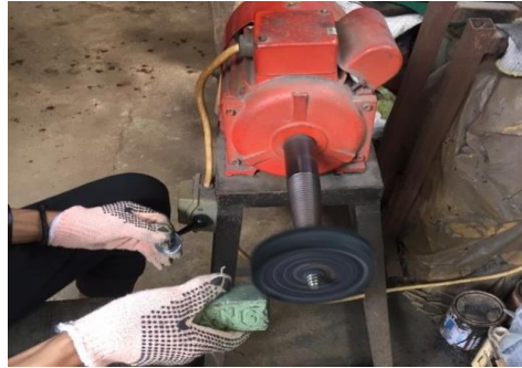
Gambar 3.15 Pembersihan secara mekanis
