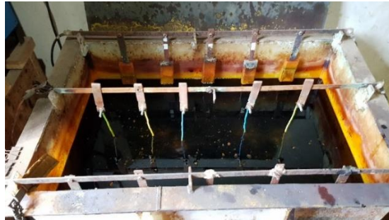
Gambar 3.21 Pelapisan kedalam larutan krom
