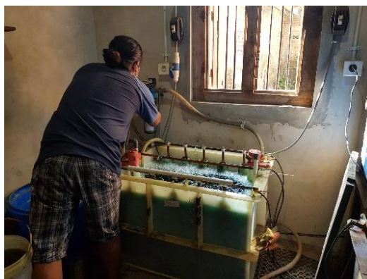
Gambar 3.19 Pemanasan larutan elektrolit nikel
