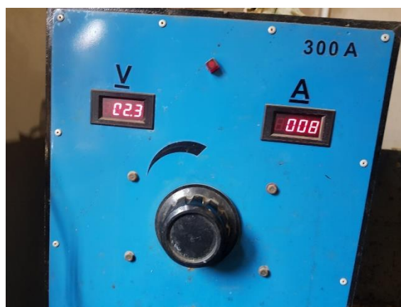
Pengaturan kuat arus pada proses pencelupan nikel
