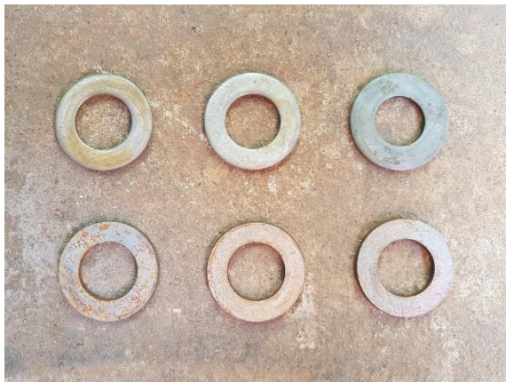
Ring Plate setelah dicelupkan di zat aditif
