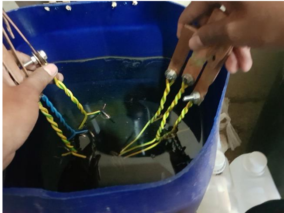
Ring Plate dicelupkan di zat aditif
