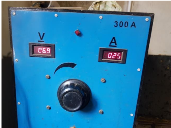
Pengaturan kuat arus pada proses pencelupan kro
