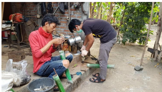
Proses Memasukkan Nikel ke Pipa Titanium
