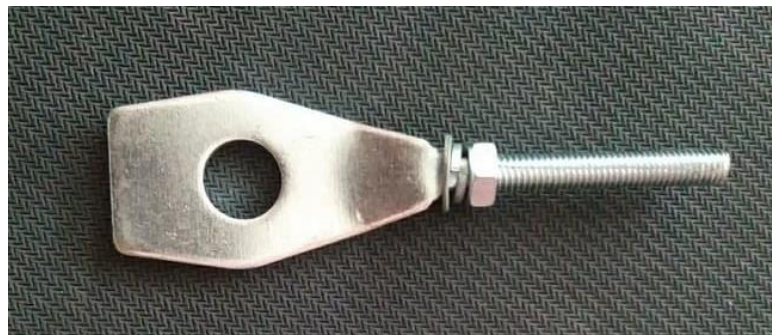
Gambar 3.5 Adjuster Chain / Pengencang Rantai
