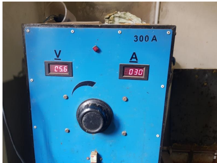
Gambar 3.1 Trafo DC/ Rectifier
