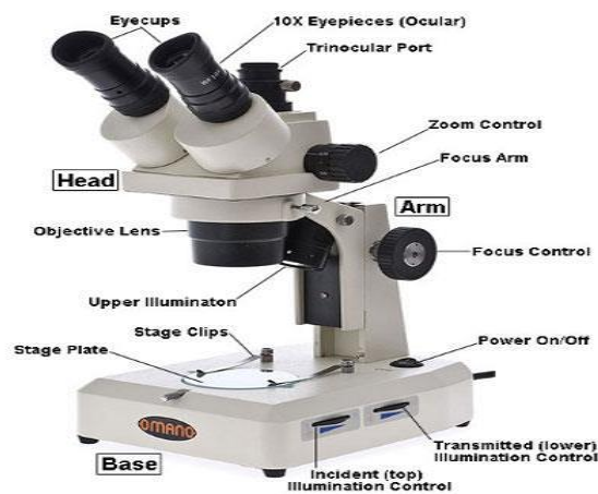
Gambar 2.8. Bagian-bagian mikroskop optik.
