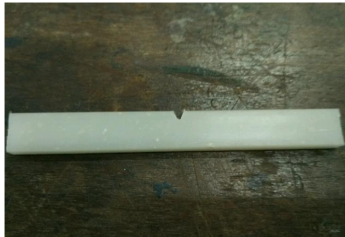
Gambar 2.5. Bentuk spesimen uji impact dengan takikan Sesuai standar ISO 179-1. (Standar ISO 179-1, 2000)
