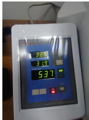
Gambar hasil uji kekerasan benda variasi 1.8V 30 menit
