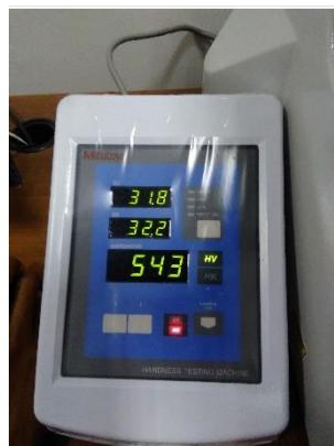
Gambar hasil uji kekerasan benda variasi 2.3V 40 menit
