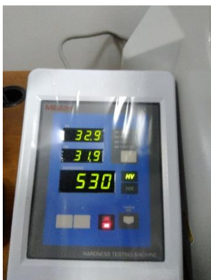
Gambar hasil uji kekerasan benda variasi 2.3V 40 menit
