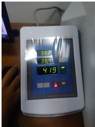
Gambar hasil uji kekerasan benda variasi 1.8V 30 menit
