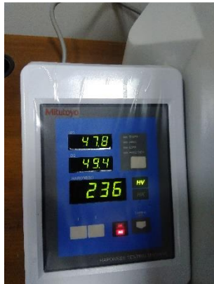
Gambar hasil uji kekerasan benda tanpa pelapisan
