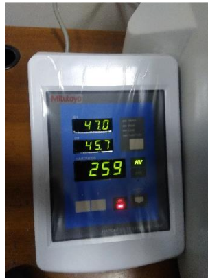
Gambar hasil uji kekerasan benda tanpa pelapisan
