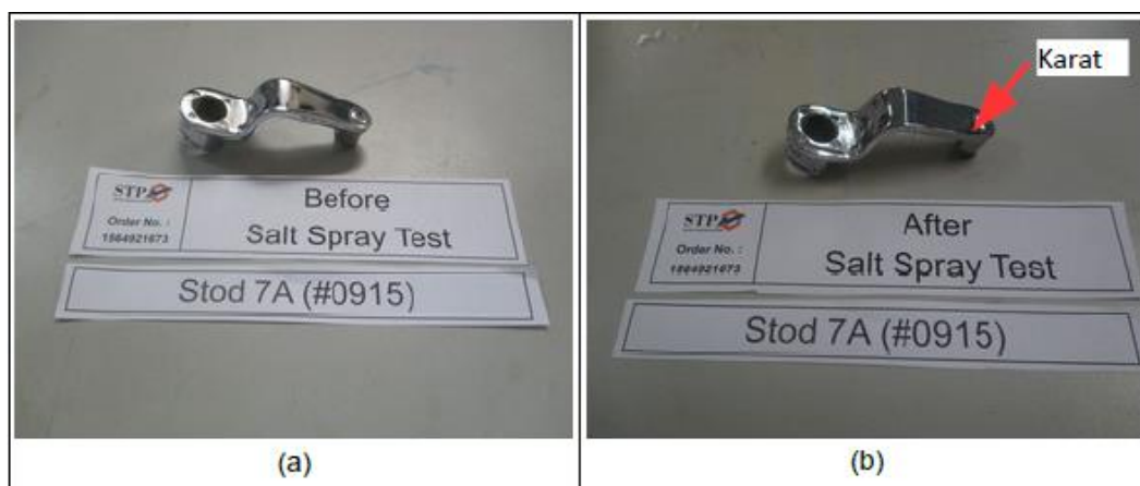
Gambar 4.6. Spesimen stod 7 A/dm 2 (a) sebelum dan (b) setelah salt spray test
