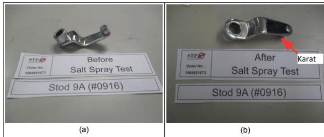
Gambar 4.7. Spesimen Stod 9 A/dm 2 (a) sebelum dan (b) setelah salt spray test
