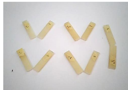
Gambar 3.9 Hasil uji ketahanan kejut variasi MC 5%.
