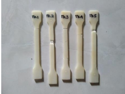
Gambar 3.7 Hasil uji tarik variasi udara terbuka.
