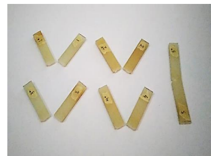
Gambar 3.11 Hasil uji ketahanan kejut variasi MC 5,5%.
