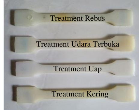
Gambar 3.2 Spesimen multipurpose setelah di treatment .
