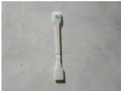
Gambar 3.9 Hasil uji tarik variasi kering.
