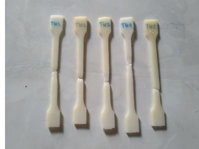
Gambar 3.8 Hasil uji tarik variasi uap.
