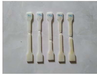
Gambar 3.10 Hasil uji tarik variasi rebus.
