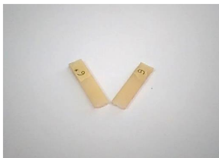
Gambar 3.10 Hasil uji ketahanan kejut variasi MC 1%.
