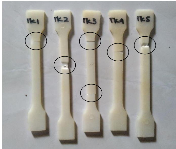
Gambar 4. 11 Patah uji tarik polyamide 6 variasi MC 0,2%.
