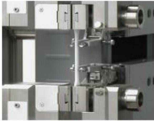
Gambar 2. 3 Pengujian tarik ISO 527-1
