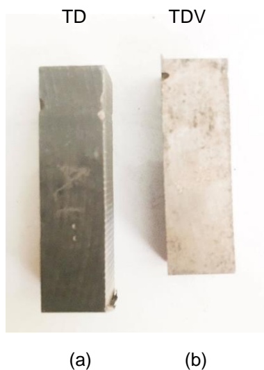
Gambar 3.1 Material SKD 11 Setelah Perlakuan Toyota Diffusion (a) dan Toyota Diffusion dengan Vacuum (b)
