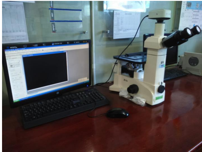
Gambar 3.21 Proses Pengambilan Gambar Mikrostruktur
