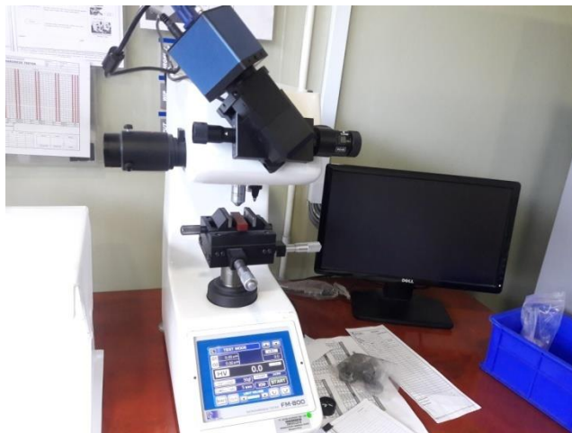
Gambar 3.19 Proses Pengambilan data Pengujian Kekerasan Vickers
