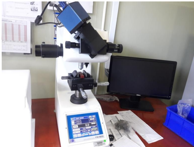
Gambar 3.14 Mesin Vickers dengan tipe Microhardness Tester FM-800
