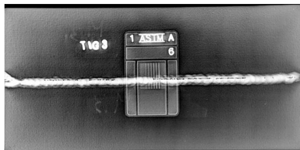
Gambar 3.5 Hasil Uji Radiografi Spesimen 95 A
