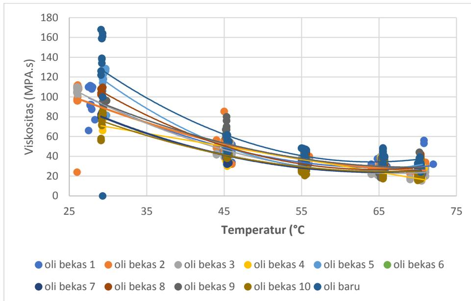
**Gambar 4.1** Perubahan Viskositas, SAE 10W30, dan Propertis A-13 Terhadap Temperatur
