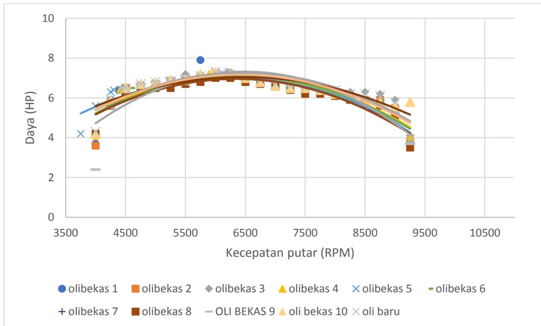
**Gambar 4.4.** Grafik kecepatan putar mesin terhadap daya (HP) dengan bahan bakar pertamax.
