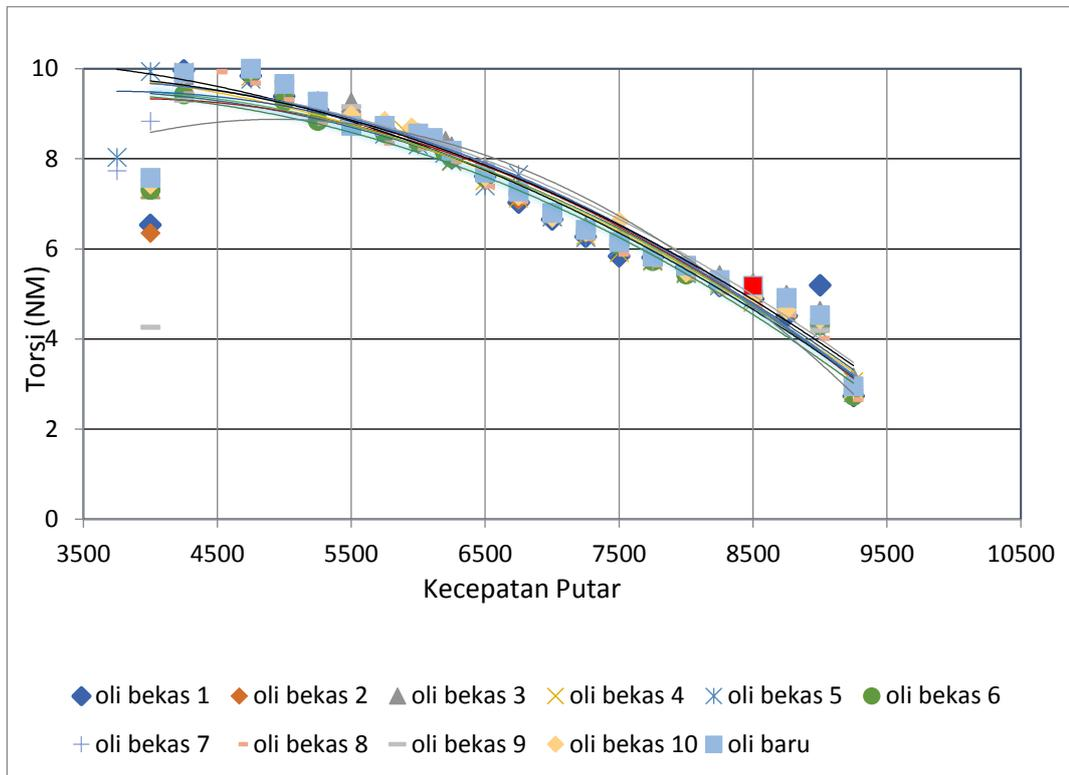
**Gambar 4.3.** Grafik kecepatan putar mesin terhadap torsi dengan bahan bakar pertamax.
