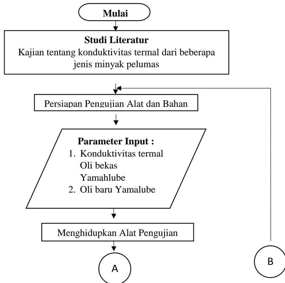
**Gambar 3.12** *Flow Chart* Pengujian Konduktivitas Termal
