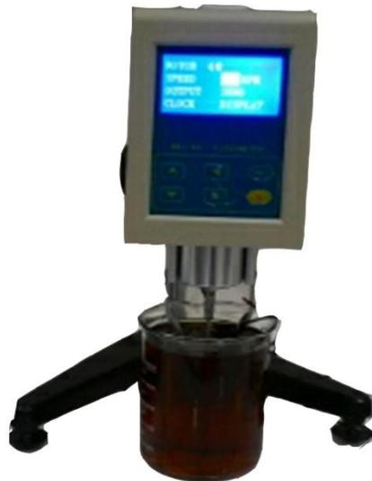
**Gambar 3.4.** Viskometer NDJ 8S
