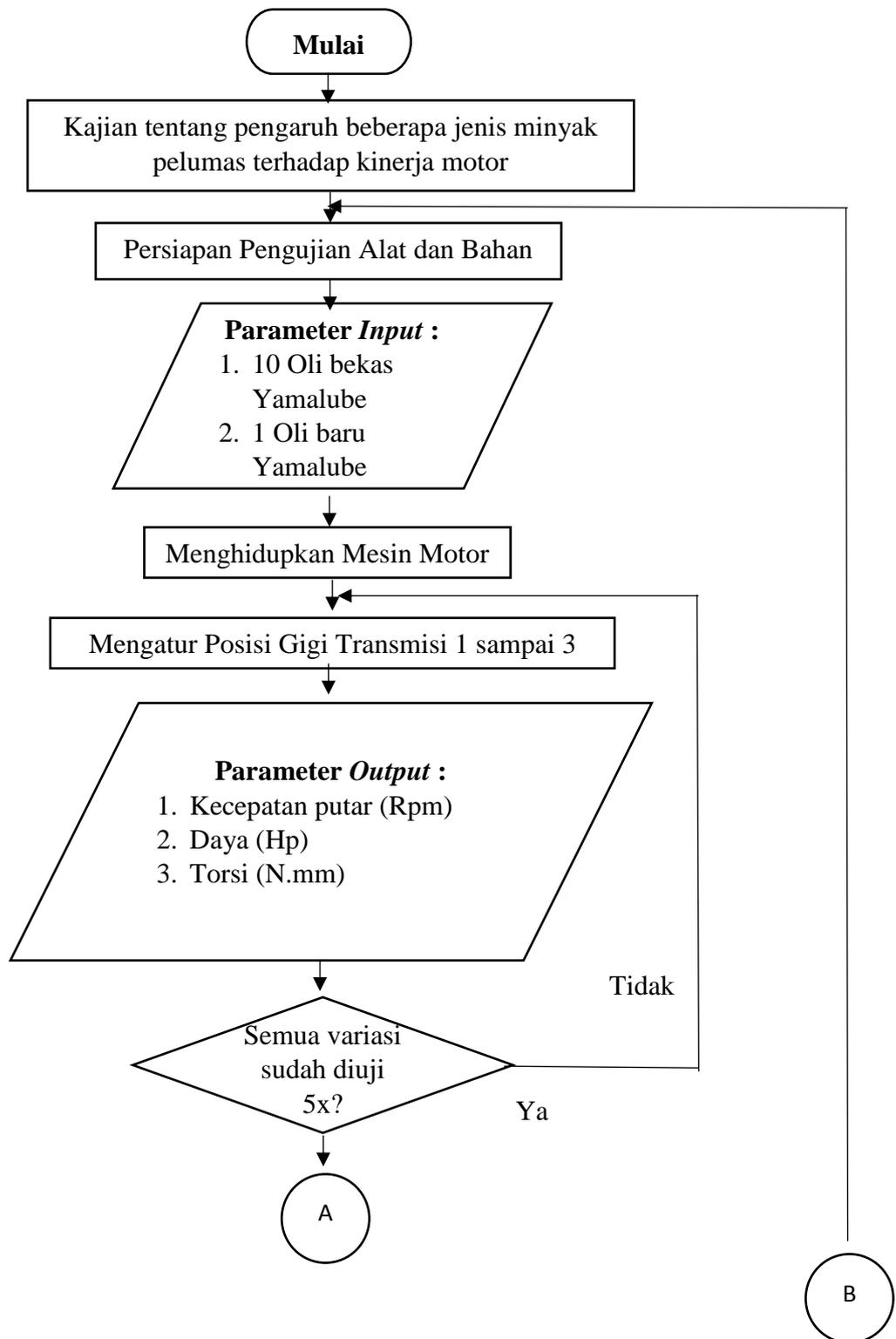
**Gambar 3.23** *Flow Chart* Pengujian Torsi dan Daya
