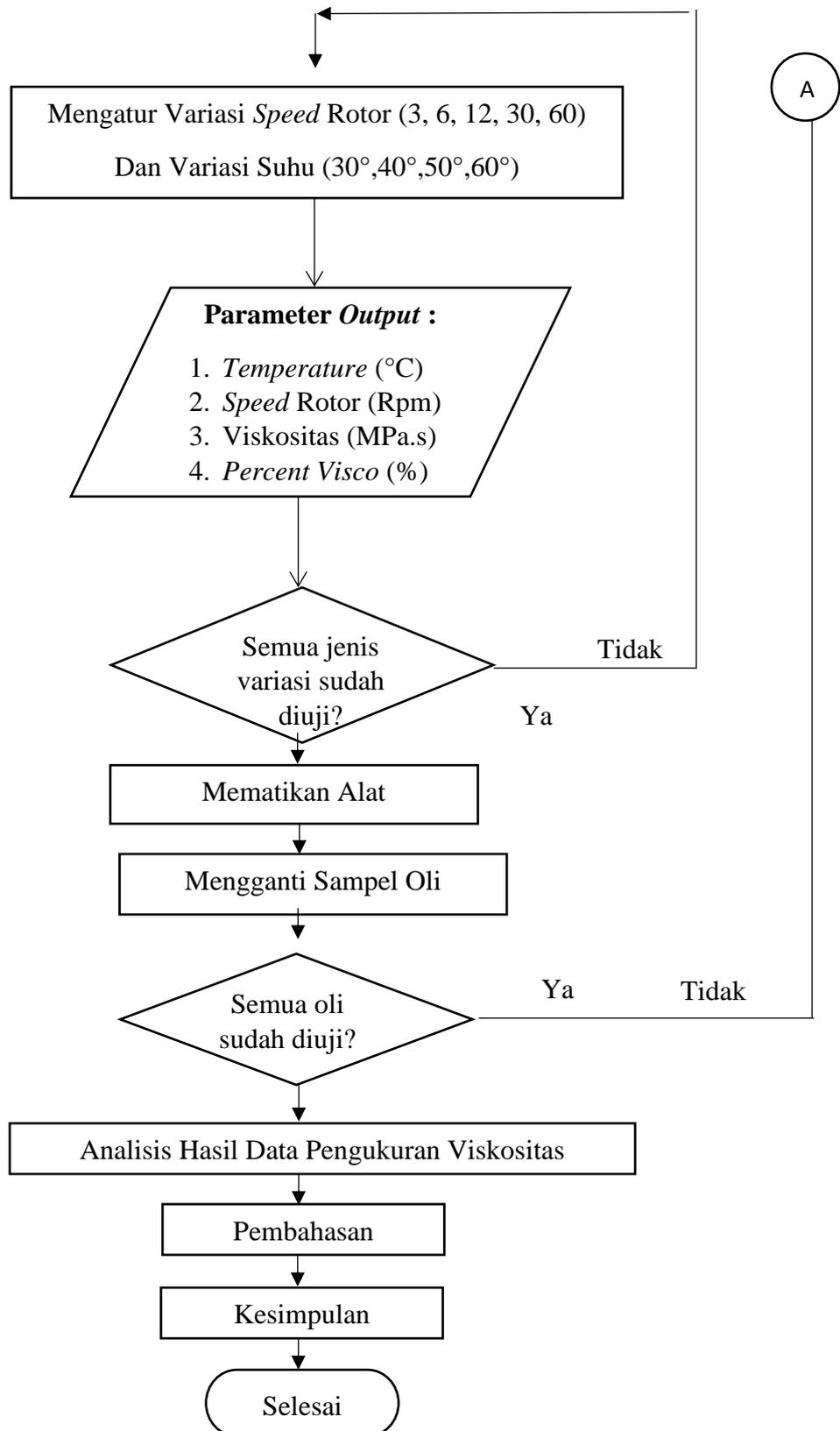
**Gambar 3.3.** Flow Chart Pengujian Viskositas (lanjutan)
