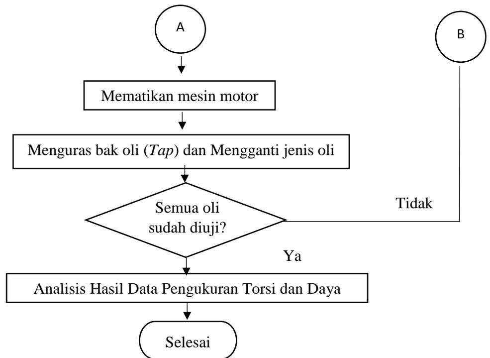
**Gambar 3.23** *Flow Chart* Pengujian Torsi dan Daya (lanjutan)
