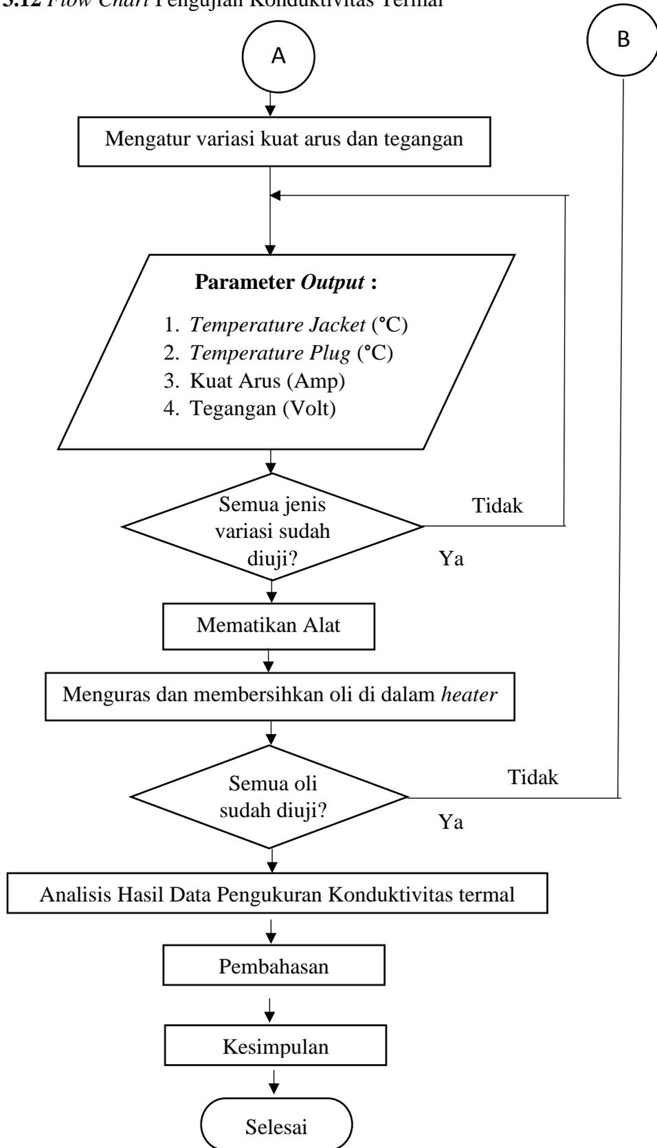
**Gambar 3.12** menunjukkan langkah kerja pengujian konduktivitas, pengujian ini dilakukan setiap satu sampel berdasarkan percobaan dan variasi kuat arus dan tegangan, keperluan kapasitas untuk pengujian satu sampel oli hanya membutuhkan  $\pm 50$  ml. pada pengujian ini dilakukan variasi kuat arus berlipat 40. Misalnya 40, 80, 120, 160, dan 200 *Ampere*.
