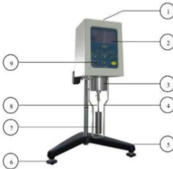
Gambar 3.26 Rangkaian Penyangga dan *Viscometer NDJ 8S*
