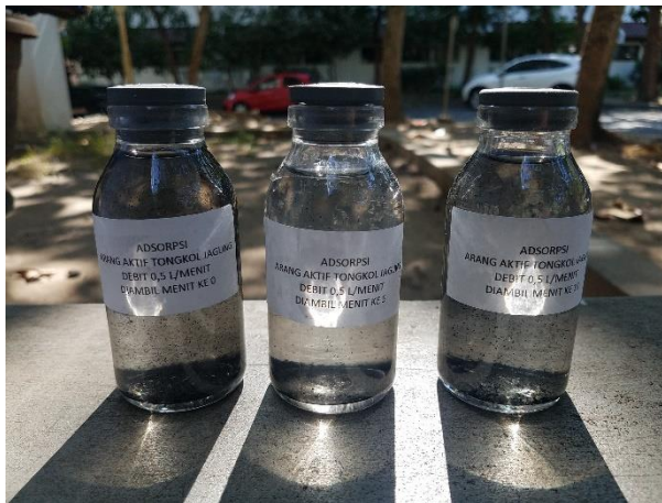
Gambar 4.3 Hasil Treatment debit aliran 0,5 liter/menit pada menit ke-0, 5, dan 10
