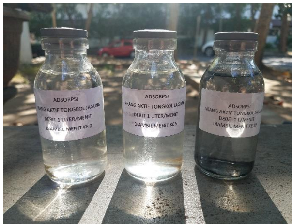
Gambar 4.4 Hasil Treatment debit aliran 1 liter/menit pada menit ke-0, 5, dan 10
