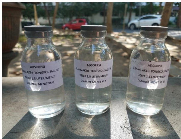
Gambar 4.5 Hasil Treatment debit aliran 1,5 liter/menit pada menit ke-0, 5, dan 10
