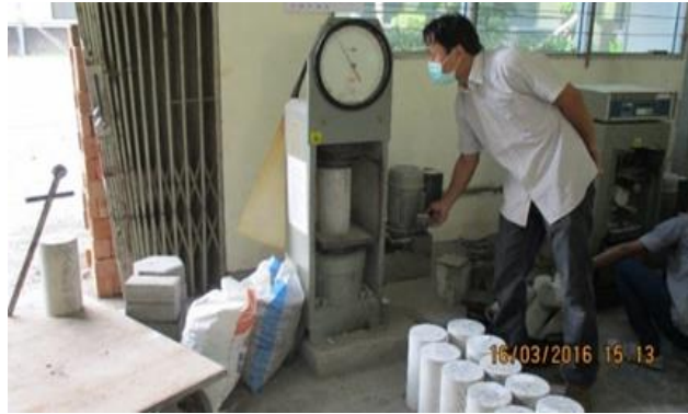
Gambar 4. 2 Proses pengujian beton
