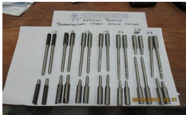
Gambar 4. 3 Proses pengujian besi
