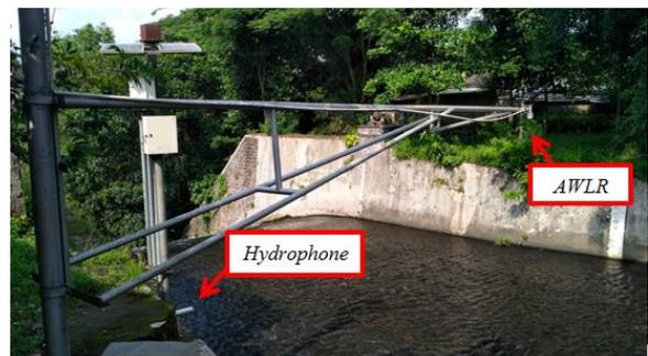
Gambar 2 Alat pemantauan tinggi muka air dan sedimen di Terjunan Gemawang
