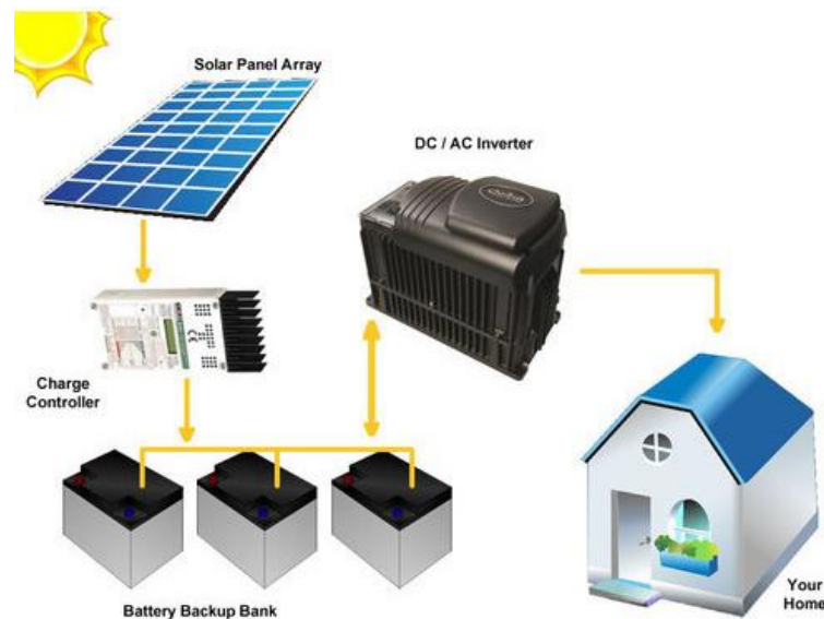
Gambar 2.2 : Sistem Off Grid PLTS
