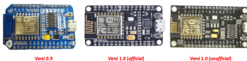
Gambar 2.7 : Versi modul NodeMCU ESP8266
