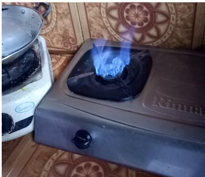
Gambar 2. Hasil nayala api pada kompor yang menggunakan biogas.
