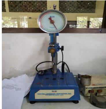
Gambar 3.7 Penetrometer
