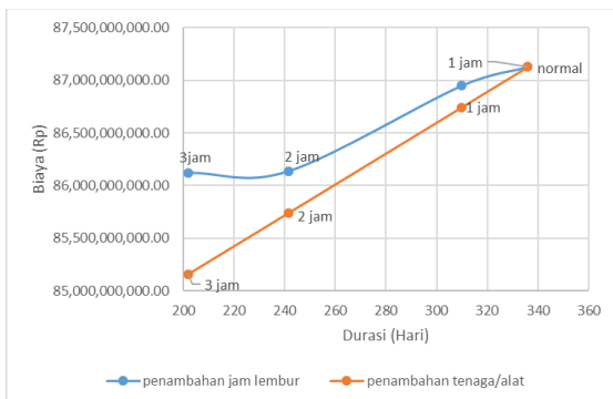
Gambar 7 Perbandingan antara titik biaya normal dengan biaya penambahan alat dan tenaga kerja dan penambahan jam lembur
