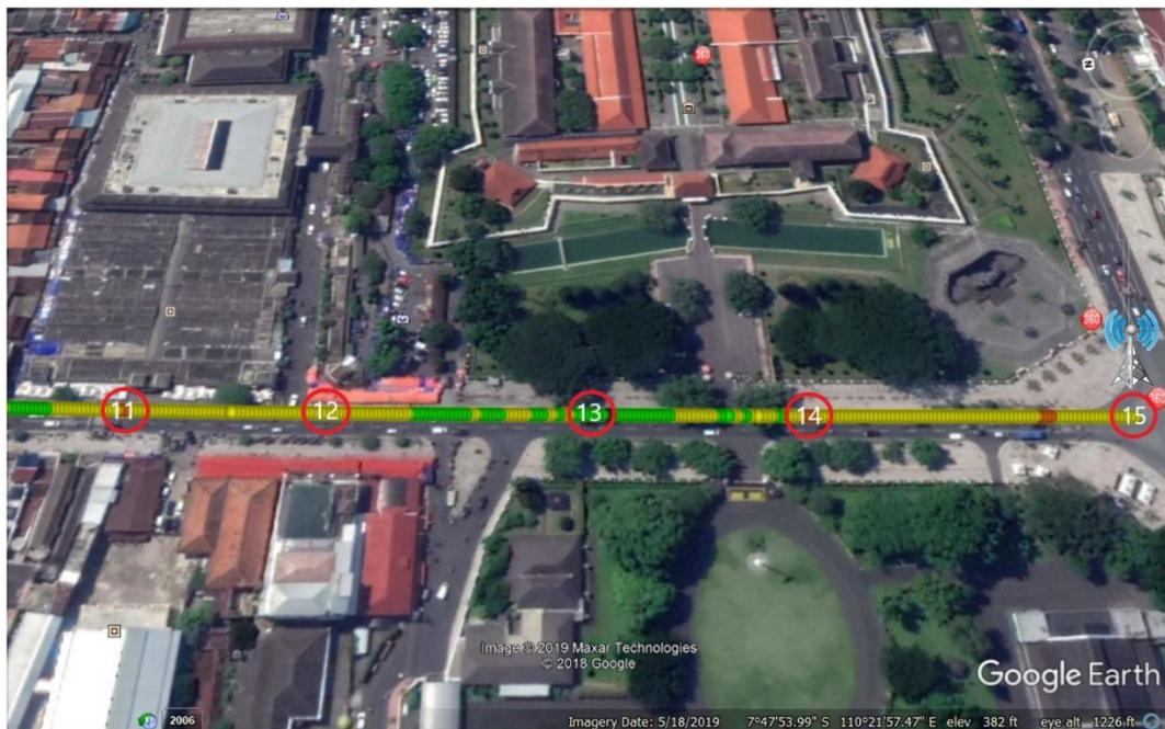
**Gambar 4.3** Hasil *Drive Test* RSRP Titik 11 sampai Titik 15
