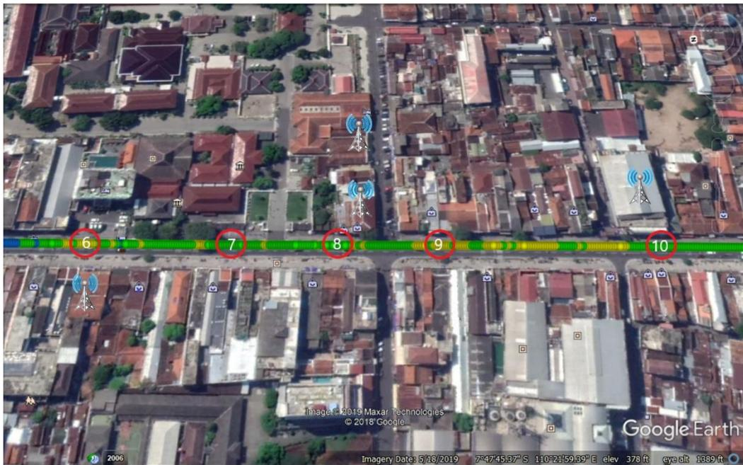
**Gambar 4.2** Hasil *Drive Test* RSRP Titik 6 sampai Titik 10
