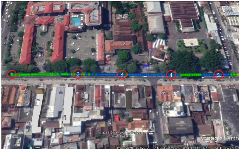
**Gambar 4.1** Hasil *Drive Test RSRP* Titik 1 sampai Titik 5
