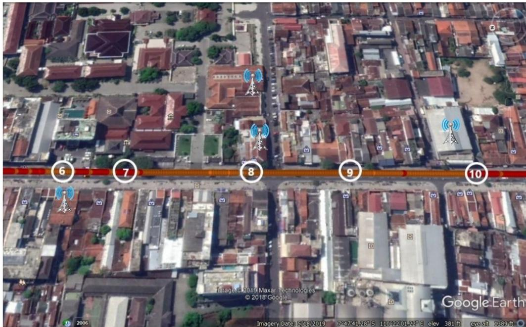
**Gambar 4.5** Hasil *Drive Test* RSRQ Titik 6 sampai Titik 10
