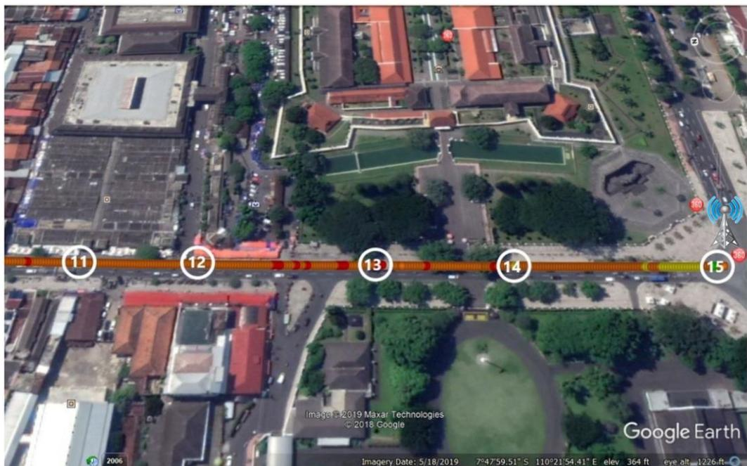
**Gambar 4.6** Hasil *Drive Test* RSRQ Titik 11 sampai Titik 15
